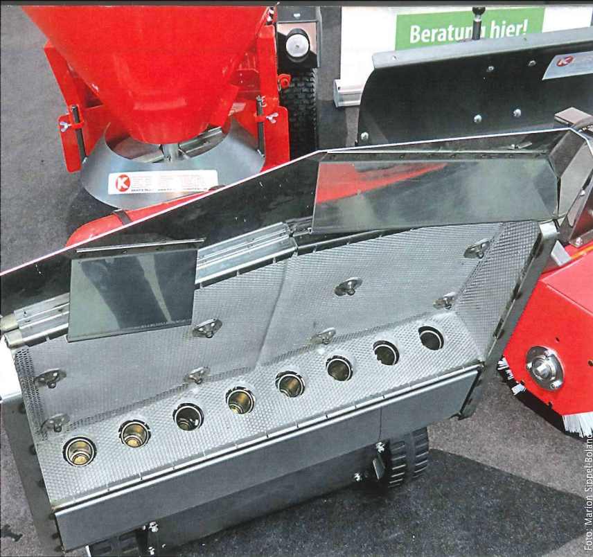
Das Leitblech des Thermhit 75 ermöglicht ein randgenaues Arbeiten.
