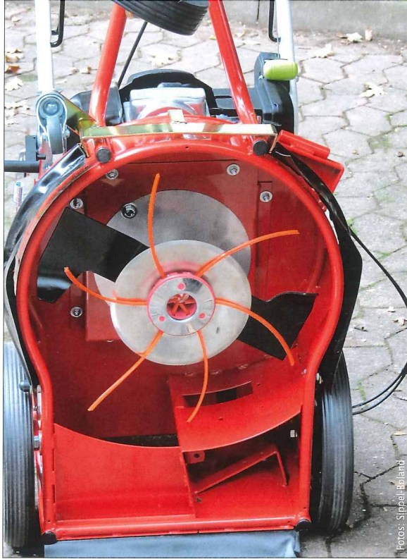
Unkraut-Jet 400: Fadenkopf mit Kunststoffäden.
