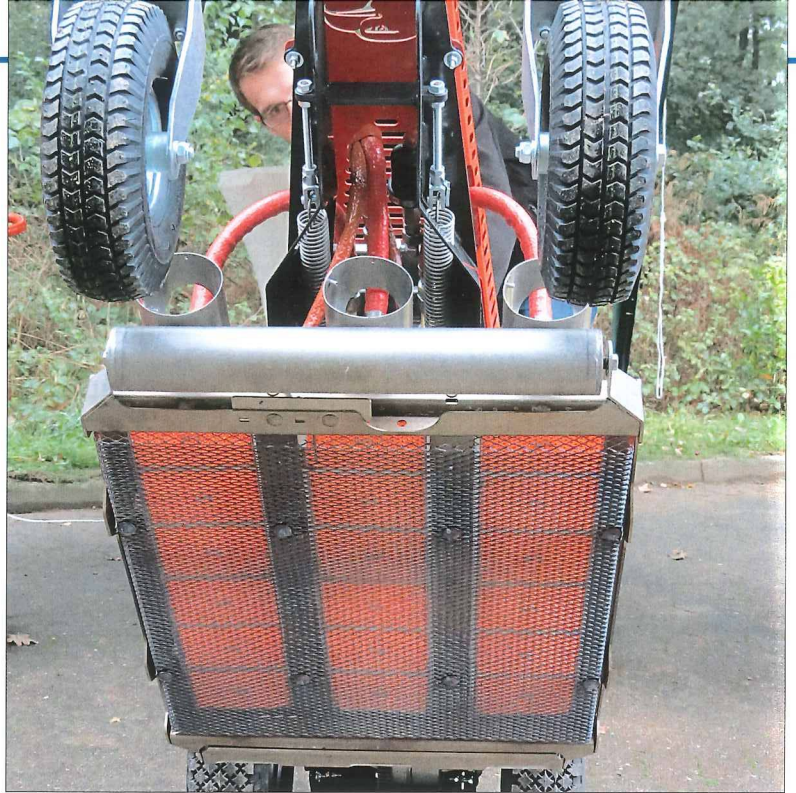
Der Heater 500 kombiniert erhitzte Keramikplatten und Infrarot-Strahlung.
