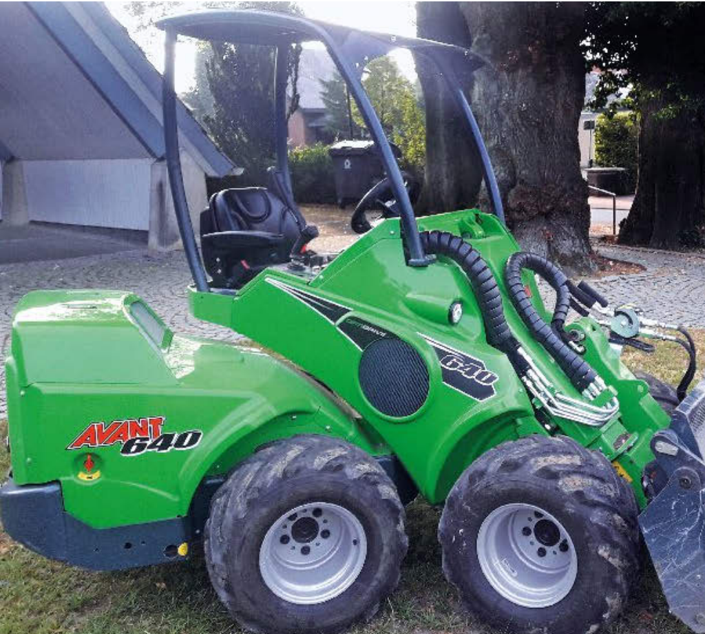
Stärker und nicht wesentlich lauter ist die dieselbetriebene Variante, hier der Multifunktionslader Avant 640.
